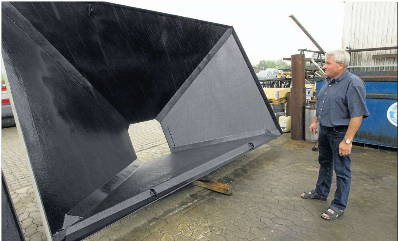
ABC Industrigummi har investeret i et anlæg, der kan sprøjte en gummibelægning direkte på større flader - som for eksempel denne store tragt, der skal bruges i forbindelse med, at lastbiler losses grus. Foto: Bjørn Armbjørn
